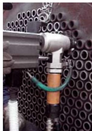
Esegue tutte le lavorazioni meccaniche di testa su tubo quali lamatura testa tubo, rimozione cordone saldatura tubo-piastra, ripristino canalina in piastra tubiera, da effettuarsi su scambiatori.
