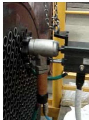
Macchina unica e completamente automatica sia in fase di bloccaggio tubo che in avanzamento mandrino portautensili, estremamente veloce, azionata tramite pedaliera o pulsante, particolarmente indicata per tutte le lavorazioni ripetitive in grande volume su caldaie e scambiatori di calore di grandi dimensioni.
