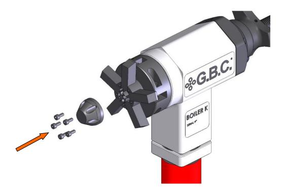
montare il coperchio di riscontro fissandolo con le apposite viti in dotazione, la macchina è pronta per l'utiliz-
