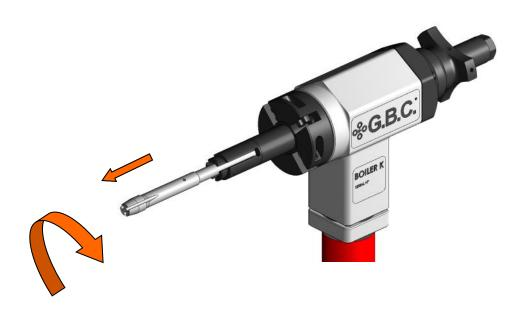
Utilizzando una pinza a becchi sottili far ruotare in senso orario l'albero espansione fino ad estrarlo.
