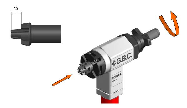
Avvitare (nel verso antiorario) l'albero espansione alette per curve con l'ausilio di una pinza a becchi sottili, finché lo stesso risulti sporgere di 20mm dalla testa, come evidenziato in figura .
