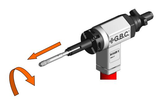
Utilizzando una pinza a becchi sottili far ruotare in senso orario l'albero espansione fino ad estrarlo.
