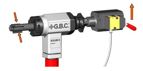
Dopo aver collegato pneumaticamente la macchina tenere premute le alette con la mano e portare la leva della valvola verso l'alto in modo che l'albero espansione rientri nella macchina tutto indietro. Se il montaggio è corretto le tre alette devono avere un leggero gioco nella propria sede.
