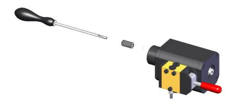
Montare la riduzione all'interno del bloccaggio per gli alberi ridotti avvitandolo fino in battuta.
