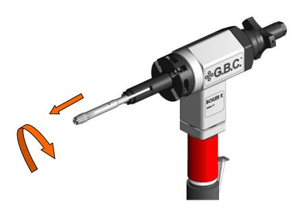
Utilizzando una pinza a becchi sottili far ruotare in senso orario l'albero espansione fino ad estrarlo.
