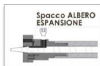
Inserire il **GRANO FINECORSA** avvitandolo fino in battuta come si vede in figura.
