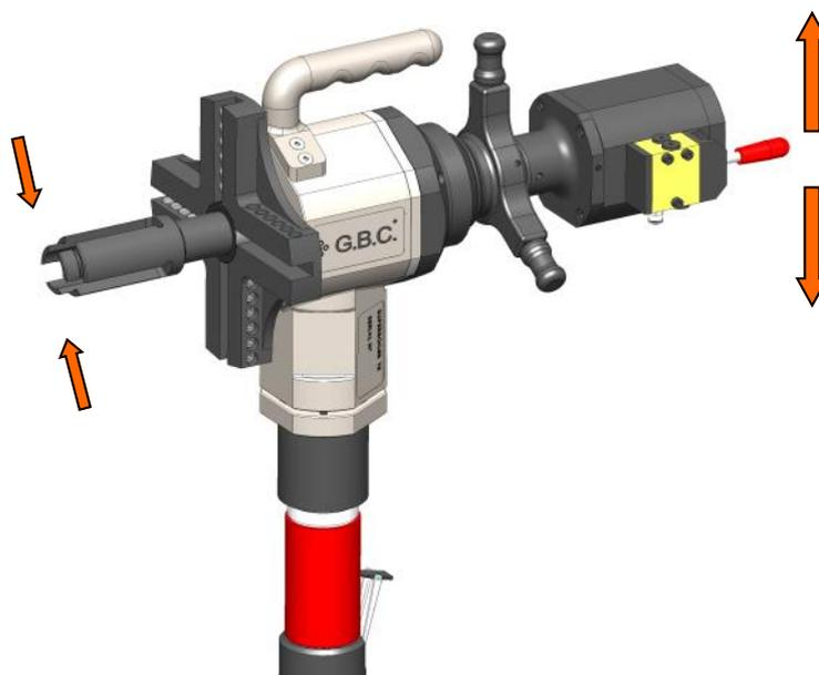
Dopo aver dato aria al bloccaggio pneumatico tenere premute le alette con la mano e portare la leva della valvola, verso il basso o verso l'alto in modo che l'albero espansione rientri nella macchina tutto indietro.
