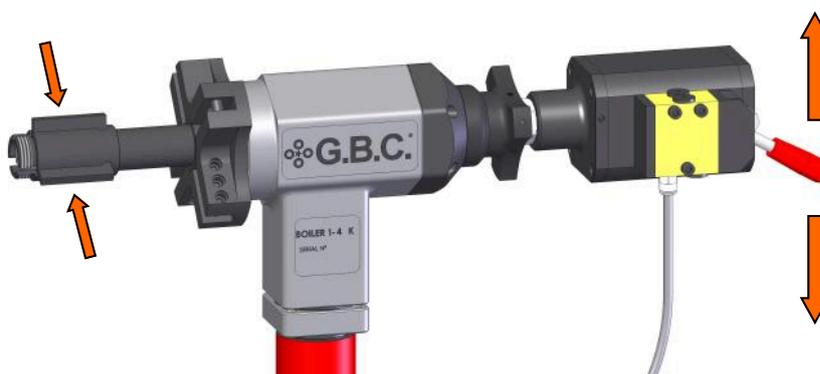
Dopo aver dato aria al bloccaggio pneumatico tenere premute le alette con la mano e portare la leva della valvola, verso il basso o verso l'alto in modo che l'albero espansione rientri nella macchina tutto indietro. Se il montaggio è corretto le tre alette devono avere un leggero gioco nella propria sede.
