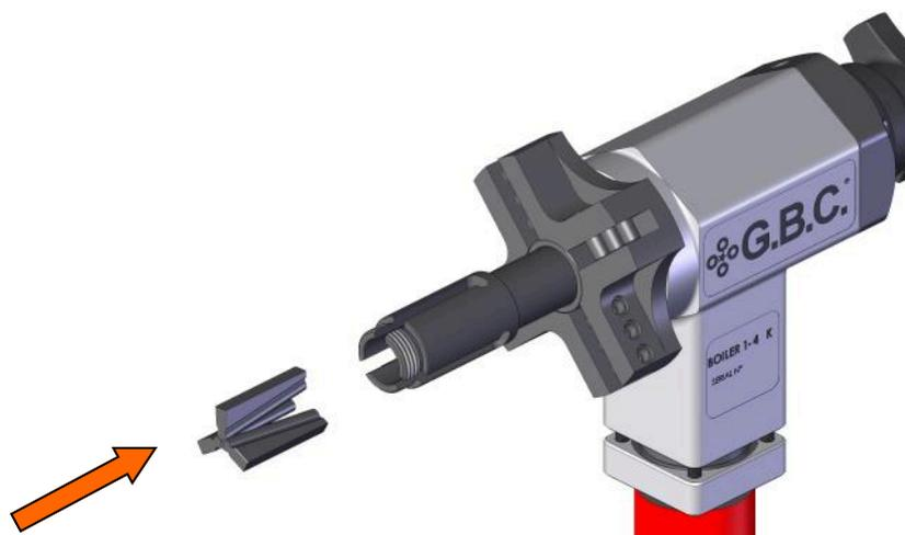
Selezionare le alette in funzione del diametro interno da lavorare e montarle all' interno dell' albero espansione alette.
