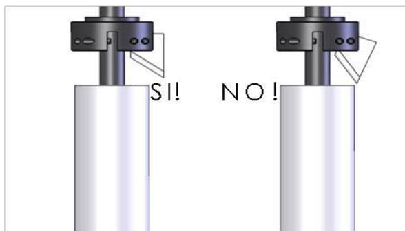
Scegliere l' utensile in funzione del tipo di smusso da eseguire e montarlo sul mandrino nell'apposita sede, quindi bloccarlo serrando con forza i grani di fissaggio. N.B. è consigliabile montare almeno due utensili contrapposti.
