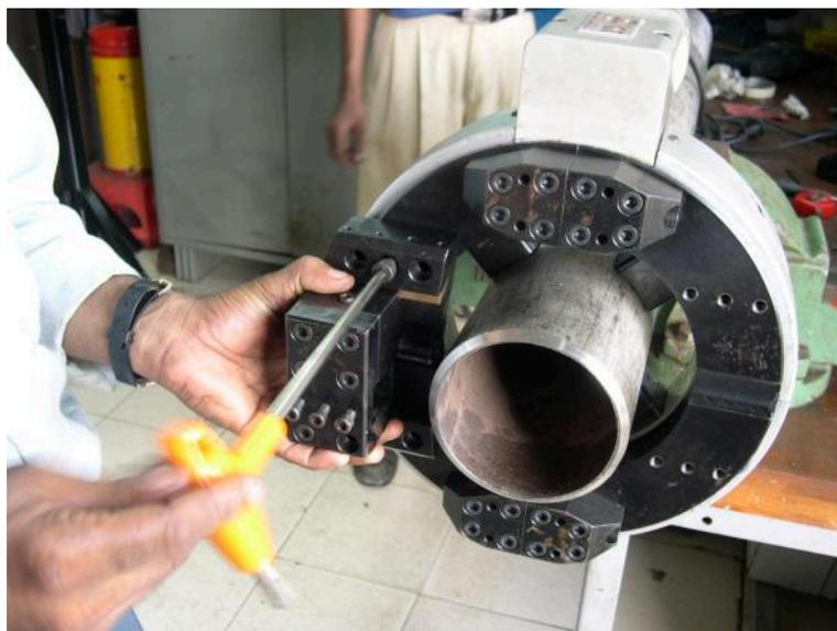
Prendere il portautensili e montarlo nella sede come mostrato in figura, posizionandolo in base al diametro del tubo; bloccarlo con le quattro viti fornite.
