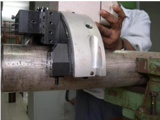
Posizionare la metà macchina con la flangia porta motore sul tubo
