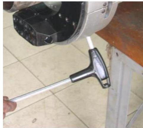
trollare che l'angolo sia esattamente 90° Serrare le ganasce come mostrato in figura.
