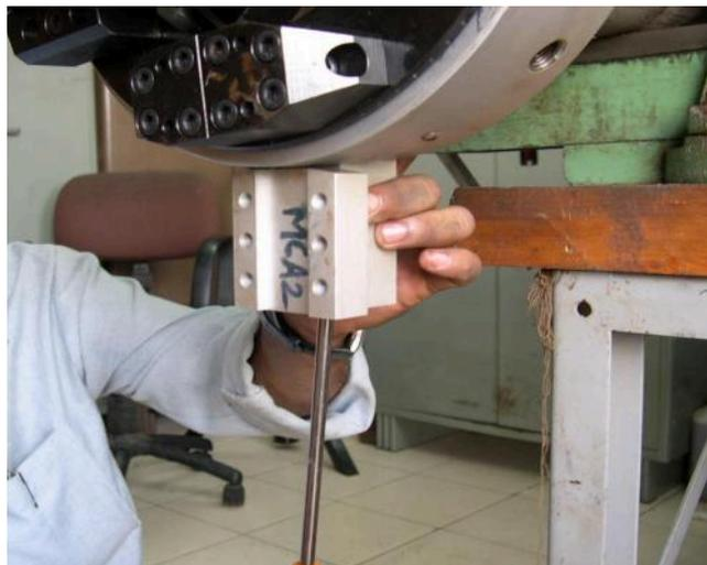
Prendere il porta striker e montarlo nell'apposita sede sul corpo macchina usando le specifiche viti di corredo.
