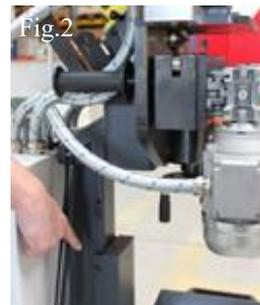
Le ruote sono dotate di freni per evitare che, nel caso la lavorazione avvenga su spezzoni di lamiera, la macchina possa muoversi.
