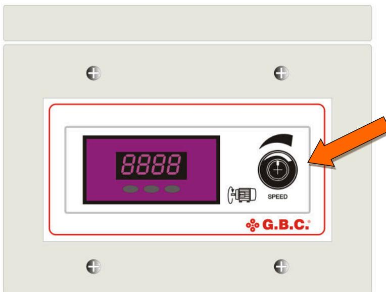
Utilizzando il potenziometro indicato in figura, regolare la velocità di rotazione della fresa in funzione del materiale da lavorare.
