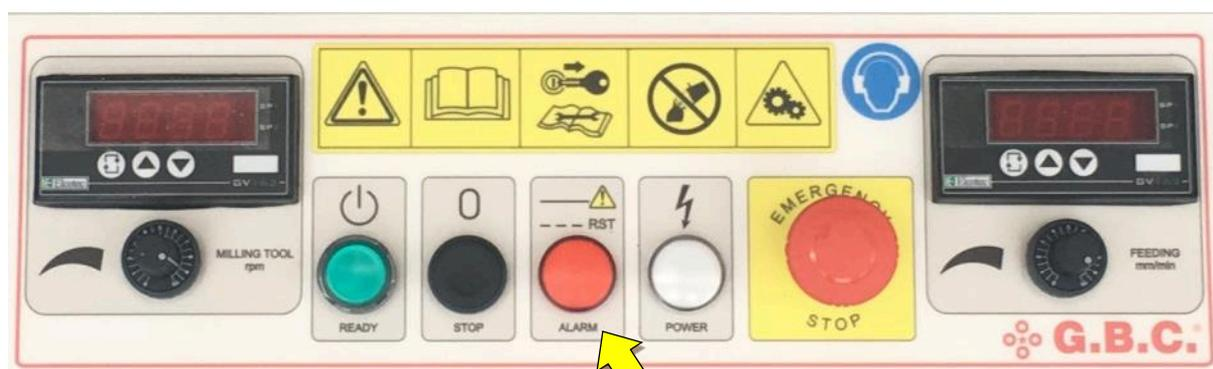
*Spia lampeggiante la macchina non parte. Invertire la fase.
