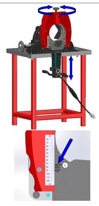
Ruotare il volantino superiore e posizionare l'asta graduata in corrispondenza del diametro desiderato da lavorare (range di bloccaggio 80 e 230mm)
