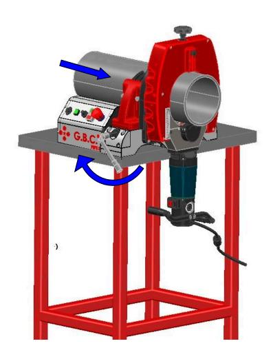
Svitare in senso antiorario il volantino frontale e posizionare far scendere il cuneo di riferimento sul tubo fino alla misura del taglio desiderata e bloccare il volantino. Bloccare il tubo sul punto di taglio serrando a fondo la vite della morsa con la chiave in dotazione.
