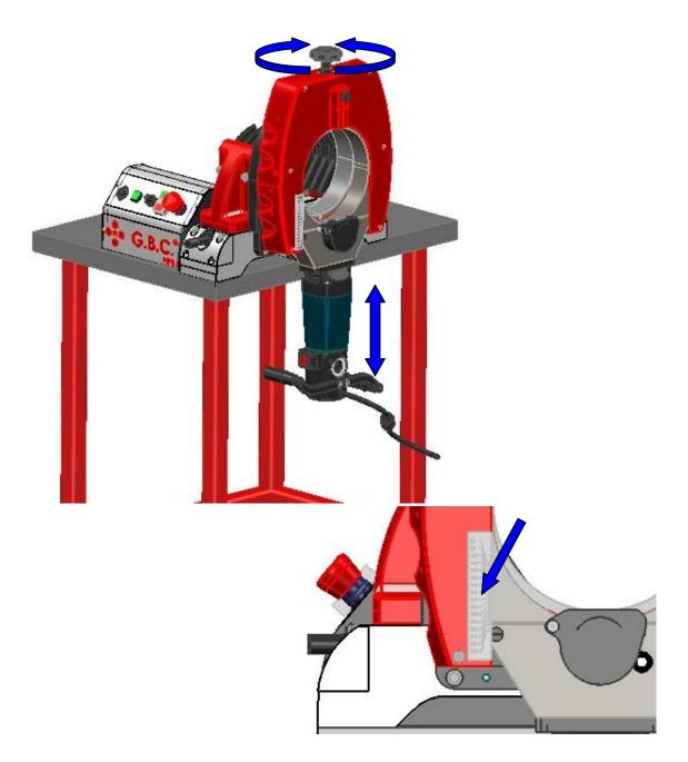
Ruotare il volantino superiore e posizionare l'asta graduata in corrispondenza del diametro desiderato da lavorare (range di bloccaggio 80 e 230mm)
