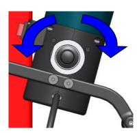
Variare la velocità di taglio della fresa in funzione del materiale e dello spessore del tubo, ruotando la manopola del regolatore di velocità, situato alla base del motore come evidenziato (vedi figura)
