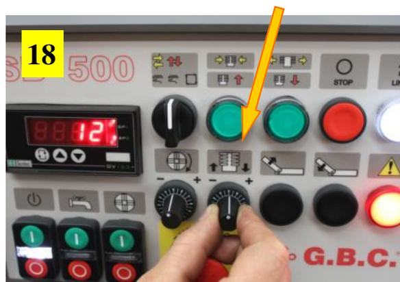
16) Controllare che il selettore (**Bloccaggio/ Avanzamento testa/Automatico**), sia in posizione centrale, in corrispondenza di Avanzamento testa/Ritorno testa, (**Frecce rosse**) come evidenziato in figura.
