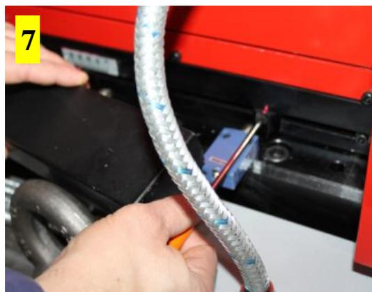
4) Svitare le viti che fissano il carter dei finecorsa e spostarlo per avere accesso alle camme.
