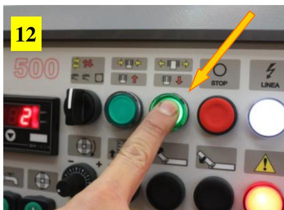
11) Controllare che il selettore (**Bloccaggio/ Avanzamento testa/Automatico**), sia orientato verso bloccaggio tubo (**Freccie gialle**) come evidenziato dalla freccia.
