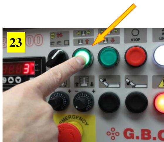
22) Ruotare il selettore in posizione (**AUTO**), come si vede in figura.
