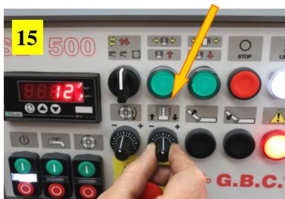
13) Posizionare il selettore (**Bloccaggio/ Avanzamento testa/Automatico**), centralmente, in corrispondenza di **Avanzamento testa/Ritorno testa (Freccie rosse)** come evidenziato in figura.
