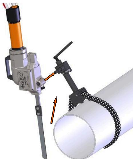
Posizionare il seghetto inserendolo nell'apposita spina del blocchetto in modo che la lama guardi verso il basso ed il seghetto abbia più o meno un'inclinazione di 45° rispetto all'asse del tubo come si vede in figura
