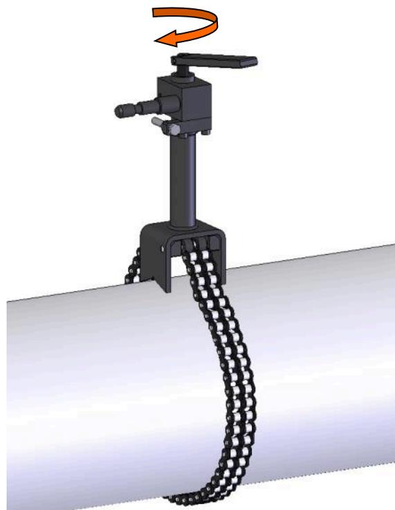
Bloccare il dispositivo bloccaggio a catena sul tubo posizionando la catena sul gancio tirante e ruotare in senso orario la maniglia per fissare il dispositivo
