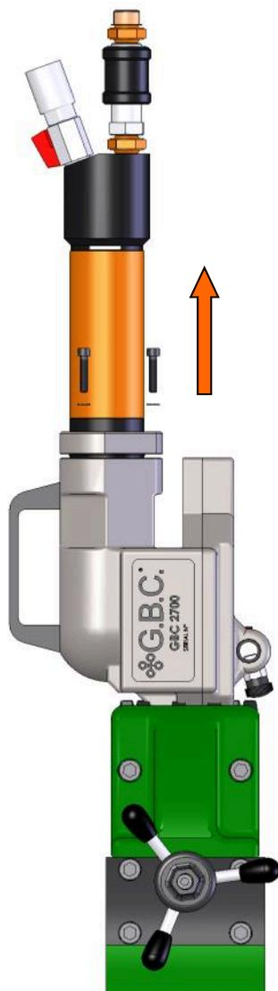
Bloccare la macchina in una morsa dotata di ganasce in alluminio, dalla parte della cassa, come illustrato in figura, quindi svitare e togliere le 3 viti e relative rondelle.
