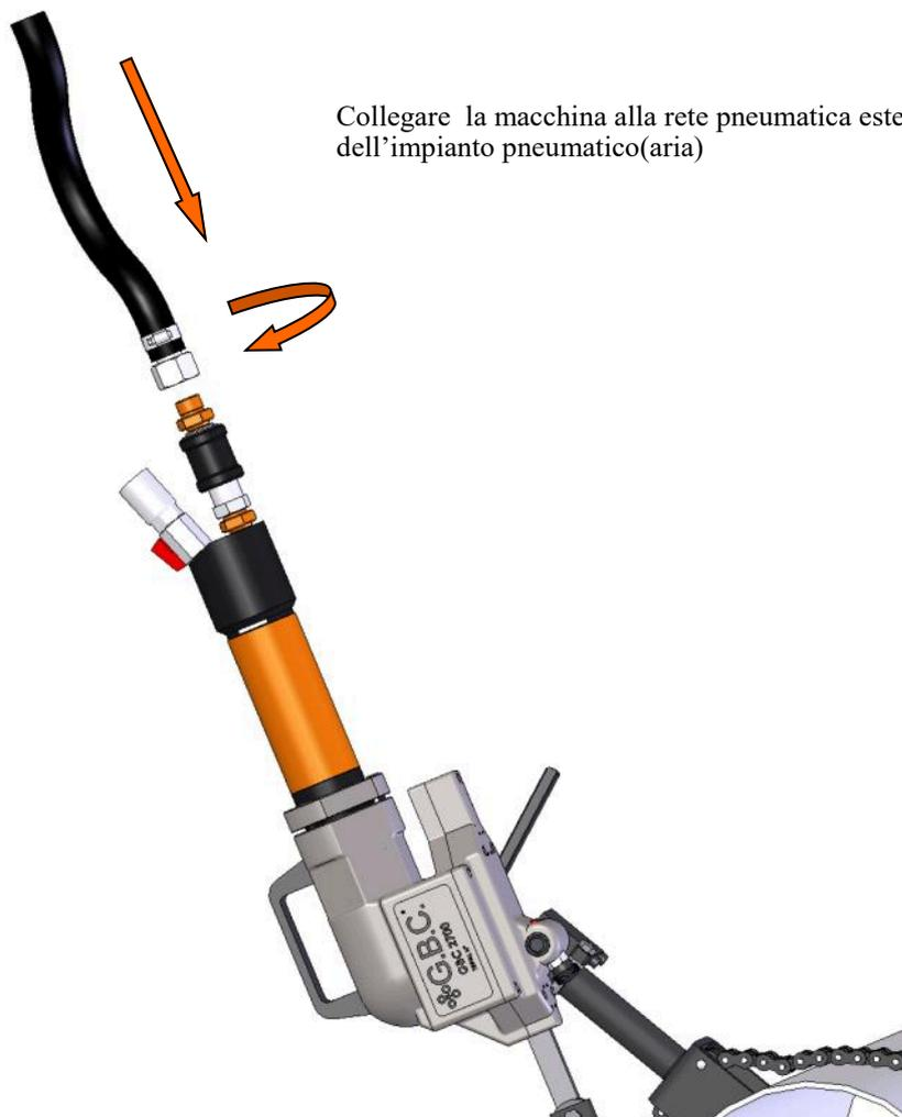
Collegare la macchina alla rete pneumatica esterna ed aprire il rubinetto dell'impianto pneumatico(aria)
