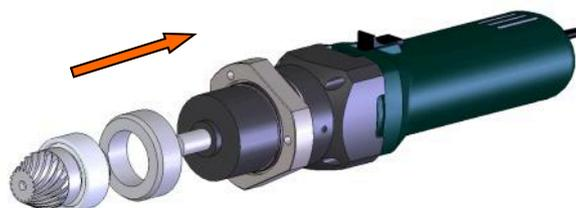
Infilare il distanziale motore orientato come si vede in figura, successivamente inserire il gruppo pignone, sull'albero motore, facendo attenzione ad orientarlo in linea con la chiave.
