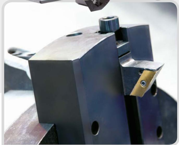
L'unità può utilizzare utensili facilmente intercambiabili per la realizzazione di smussi di qualsiasi forma e angolazione. In relazione al materiale da lavorare sono disponibili in diverse tipologie:
