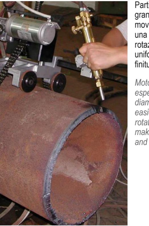
Particolamente indicato su grandi diametri, facilita la movimentazione e garantisce una velocità costante di rotazione rendendo più uniforme e precisa la finitura del taglio.
