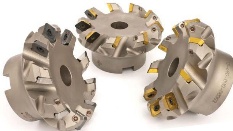
La fresa in dotazione alla Basic Edge 50 possiede 5 slot per inserti e, come la fresa per gli altri modelli, può essere anch'essa equipaggiata differenti tipologie di inserti, a seconda del materiale che si deve lavorare (acciaio al carbonio, acciaio inox, duplex, super duplex, inconel, alluminio etc.). Ogni inserto ha 4 lati taglienti, pertanto sarà utilizzabile per 4 cicli completi di lavoro.
