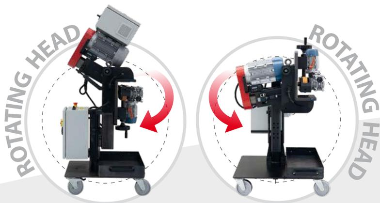
La macchina è dotata di testa ad angolo variabile da 10° a 70°, che permette di modificare l'angolo di smusso con una operazione molto semplice e veloce.
