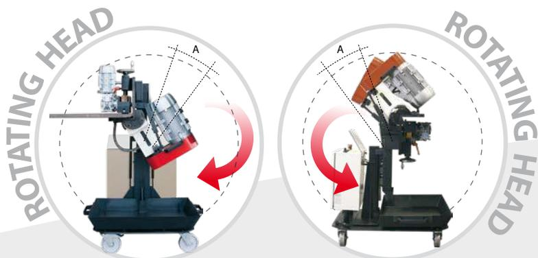
La macchina è dotata di testa ad angolo variabile da 15° a 60°, che consente di modificare l'angolo di smusso con un'operazione molto semplice e veloce.
