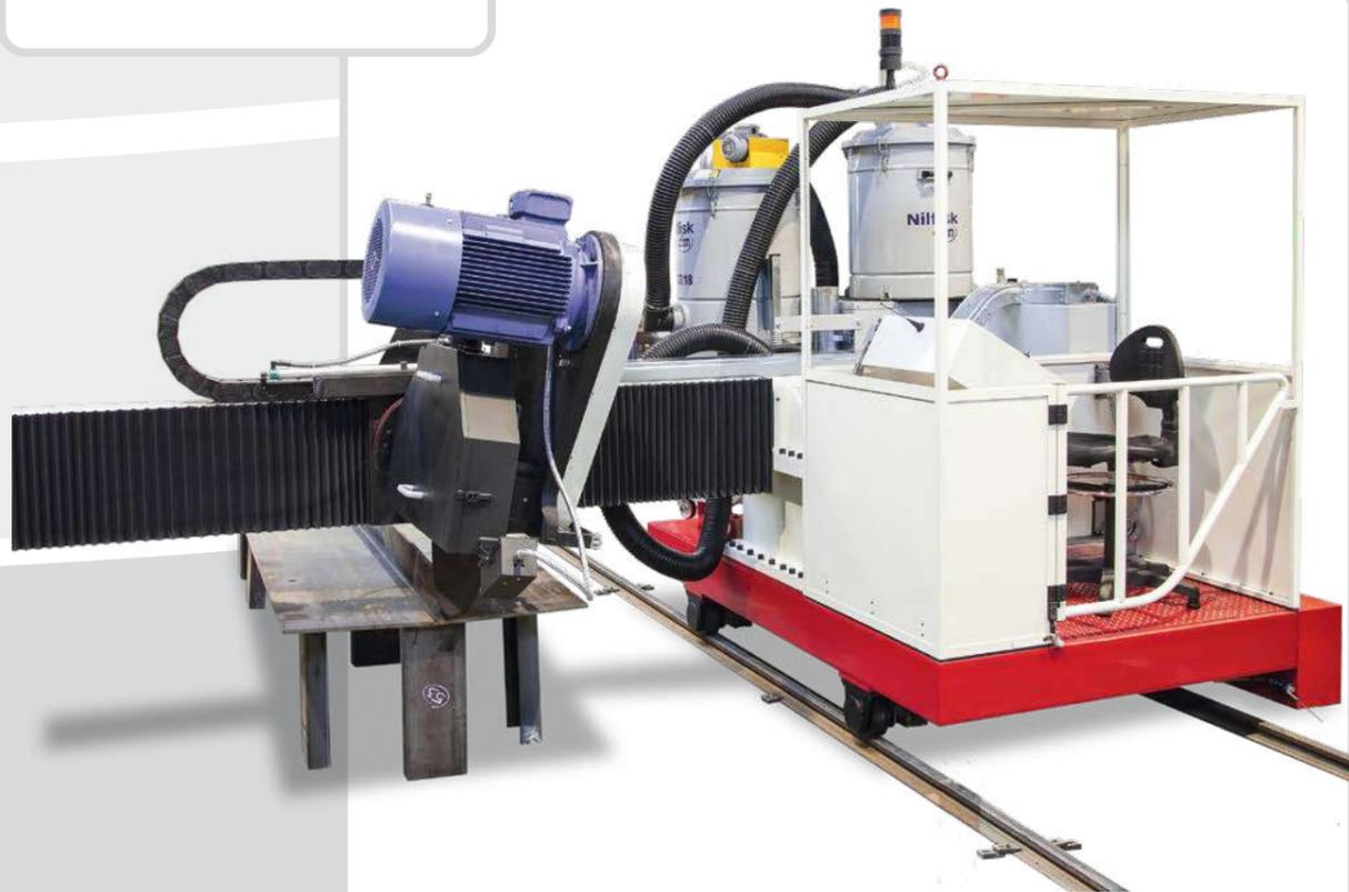
La macchina, totalmente elettronica ed equipaggiata con motore brushless permette il controllo in remoto delle principali funzioni, mentre il pannello LCD, collegato a una telecamera ad alta definizione, consente di monitorare visivamente l'operatività della macchina.
